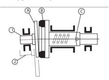
Мотор-вариаторы серии 7МВ позволяют осуществлять плавное изменение скорости с диапазоном регулирования 1:5, обеспечивая при этом отсутствие люфта выходного вала и вибраций при работе. Это стало возможным благодаря оригинальной конструкции механизма передачи вращения.
