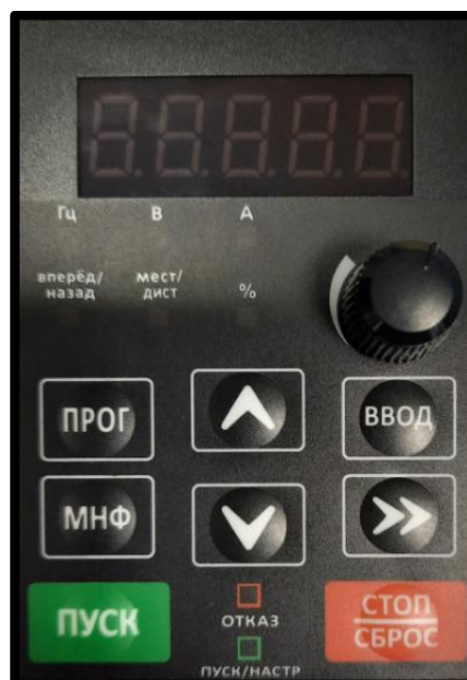
Рис. 4-1 б. Панель управления. Расположение кнопок управления и индикация
