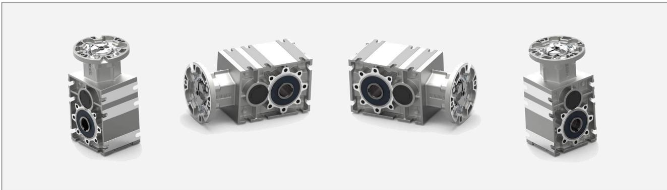
I riduttori ortogonali a due coppie, Serie RO-2, sono costruiti con carcassa monolitica, ingranaggi conici all'entrata ed una coppia cilindrica in uscita per sopportare importanti carichi esterni.
