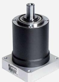
La serie dei riduttori epicicloidali a gioco ridotto tipo RG, costruita con carcassa monolitica in acciaio da bonifica sulla quale è ricavata mediante brocciatura la corona dentata interna, può alloggiare 1 o 2 stadi di riduzione.
